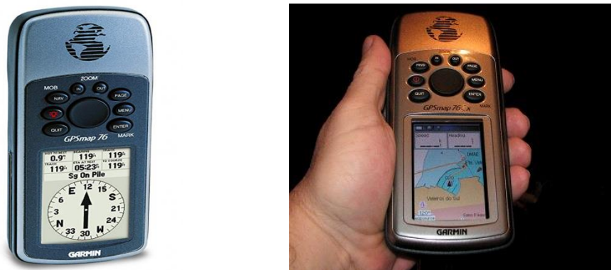
Figura 5 – GPS de Navegação Garmin map 76Sx utilizado na determinação das coordenadas de partida das estações de monitoramento.
