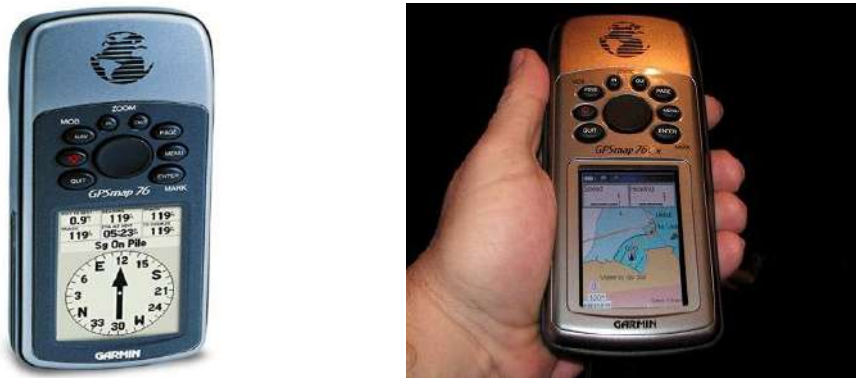
Figura 5 – GPS de Navegação Garmim map 76Sx utilizado na determinação das coordenadas de partida das estações de monitoramento.
