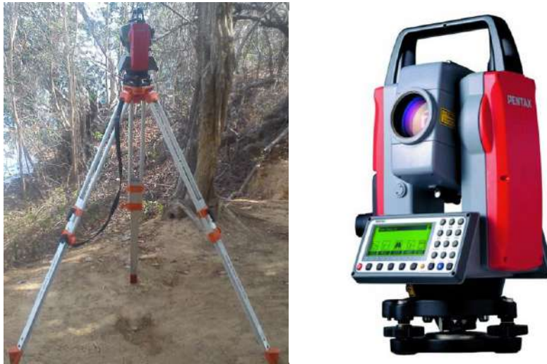
Figura 4 – Estação Total Pentax R425VN: utilizada na determinação do plano cotado e dos perfis, bem como nas leituras resultantes do levantamento planialtimétrico.
