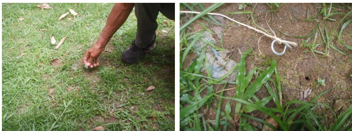
8 e 9 – Hastes de ferro utilizadas para facilitar as leituras.
