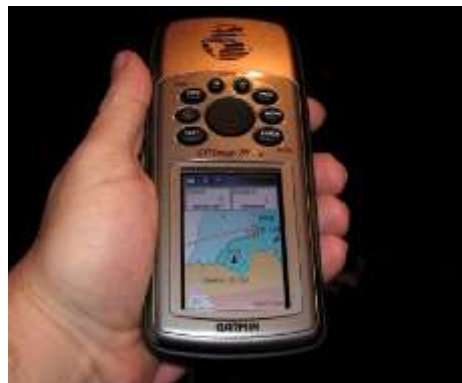
Figura 5 – GPS de Navegação Garmim map 76Sx utilizado na determinação das coordenadas de partida das estações de monitoramento.
