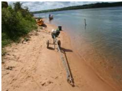
Figura 4 - "Motor de Rabeta" empregado nas embarcações da região.
