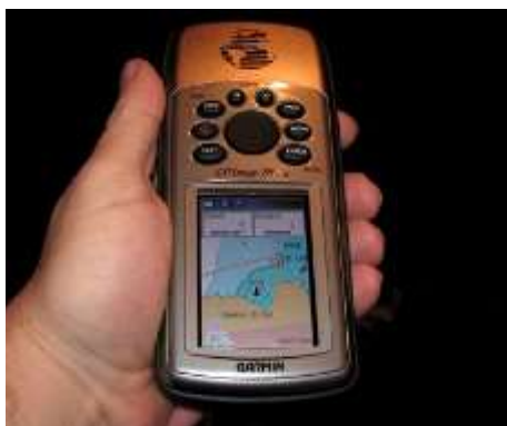
Figura 5 – GPS de Navegação Garmim map 76Sx utilizado na determinação das coordenadas de partida das estações de monitoramento.
