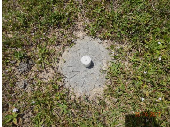
Foto 47 - Detalhe do marco topográfico M-01.
