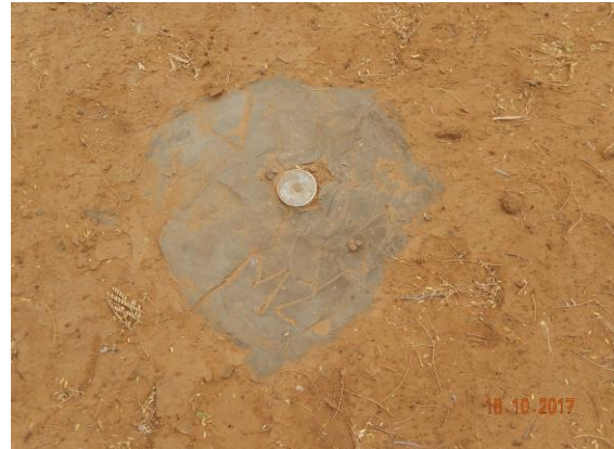
Foto 8 - Detalhe do marco topográfico M-02.
