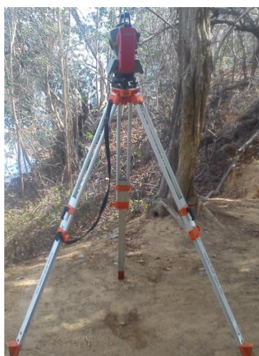
Figura 4 – Estação Total Pentax R425VN: utilizada na determinação do plano cotado e dos perfis, bem como nas leituras resultantes do levantamento planialtimétrico.
