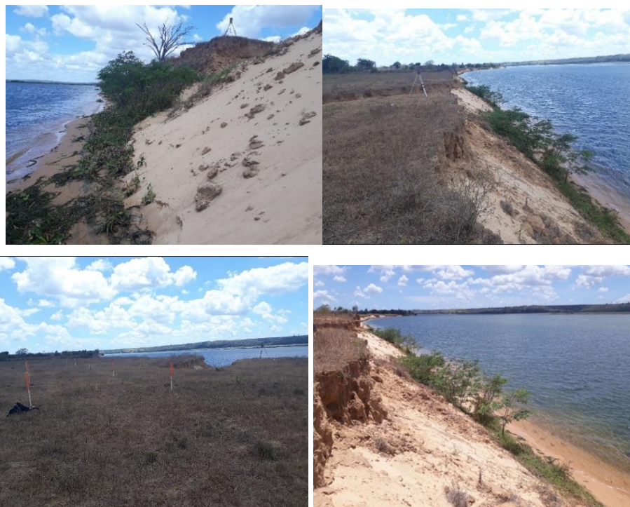
Figura 37 – Monitoramento Fotográfico da EM B-10 Talude destituído de vegetação ao nível d'água em solo arenoso.
