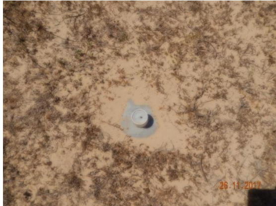
Foto 62 - Detalhe do Marco topográfico M-01.
