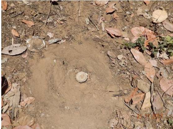
Foto 16 - Detalhe do marco topográfico M-02.
