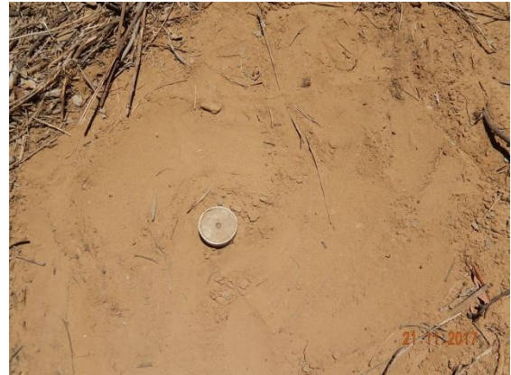
Foto 17 - Detalhe do marco topográfico M-01.
