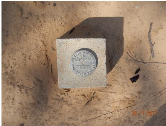
Foto 1 - Detalhe do marco topográfico M-01.
