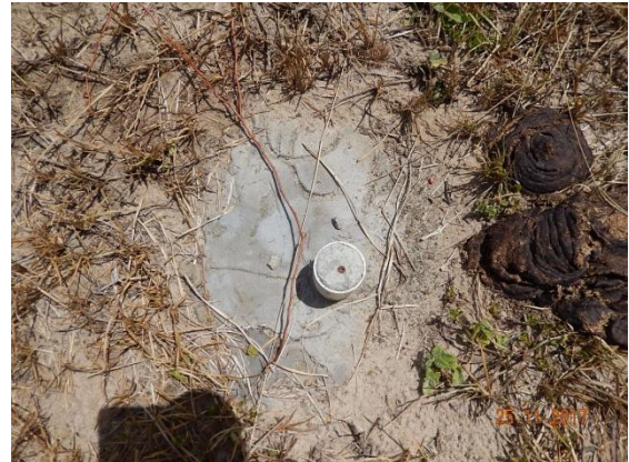
Foto 48 - Detalhe do marco topográfico M-02.
