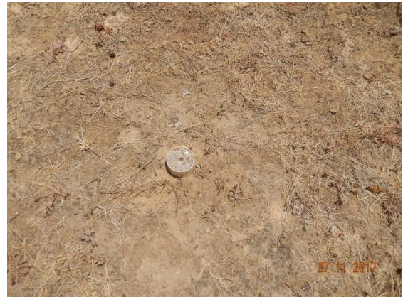
Foto 53 - Detalhe do marco topográfico M-02.
