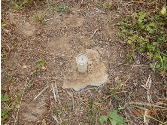
Foto 68 - Detalhe do marco topográfico M-02.
