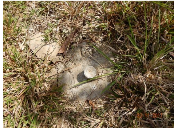
Foto 27 - Detalhe do marco topográfico M-02.
