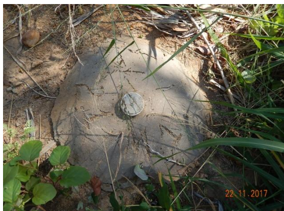
Foto 13 - Detalhe do marco topográfico M-01.
