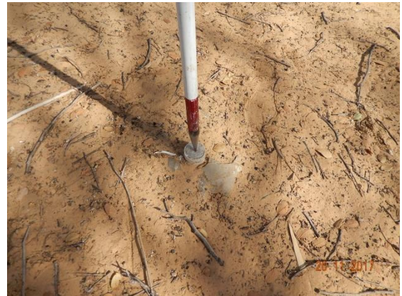
Foto 2 - Detalhe do marco topográfico M-02.
