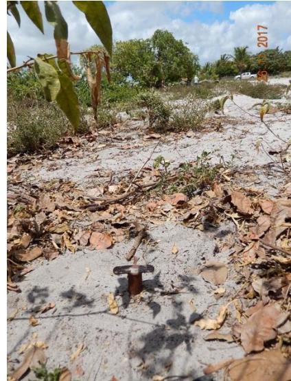
Foto 39 - Detalhe do marco topográfico M-02.
