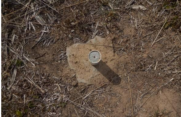
Foto 69 - Detalhe do marco topográfico M-02.
