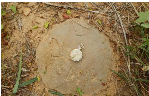
Foto 13 - Detalhe do marco topográfico M-01.
