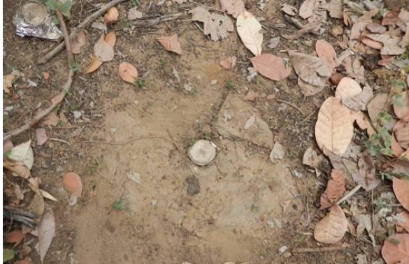
Foto 17 - Detalhe do marco topográfico M-02.
