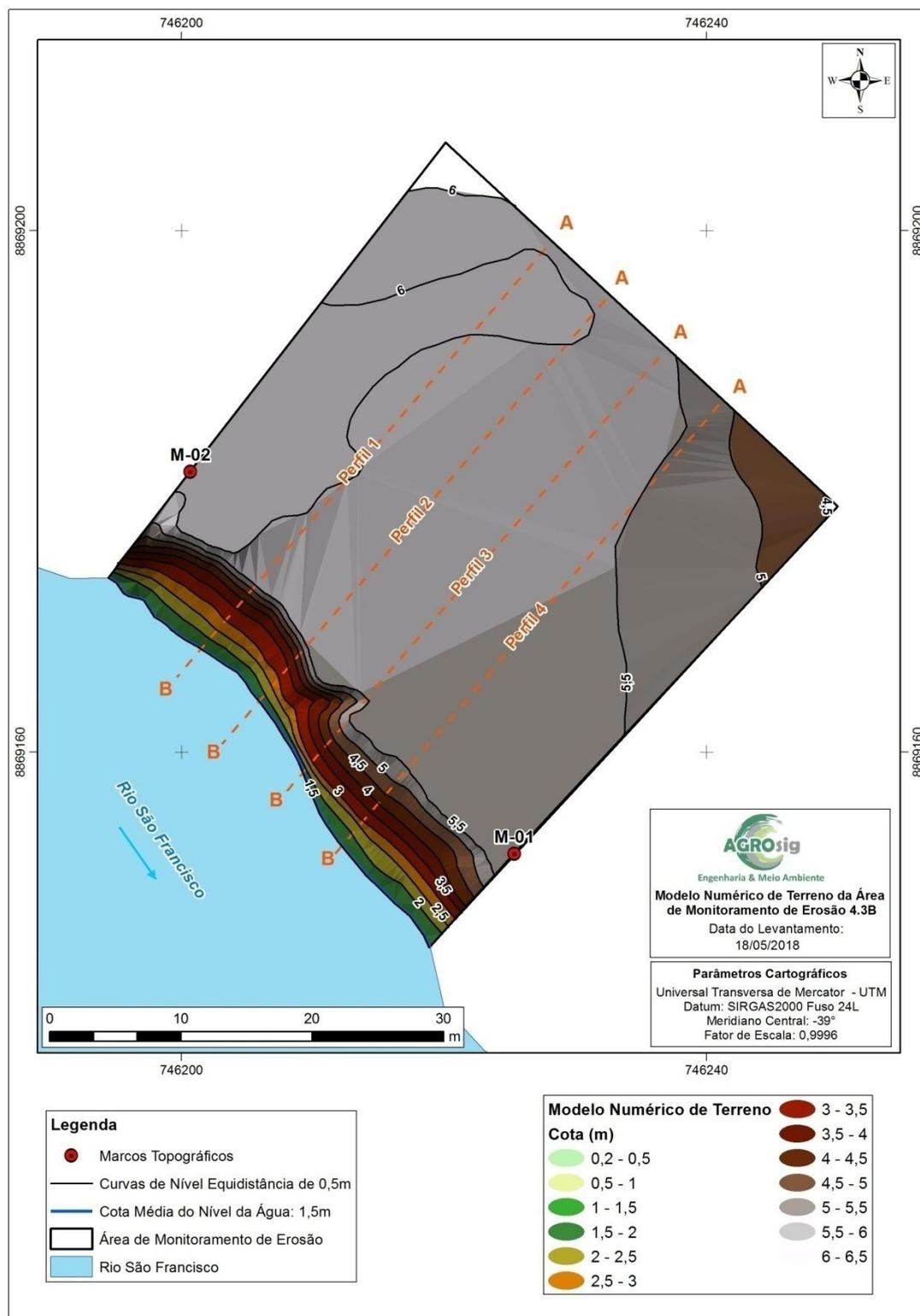
**Figura 22 - Modelo Numérico de Terreno da Área 4.3B.**
