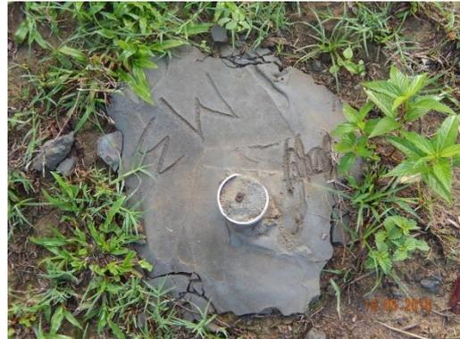
**Foto 28 - Detalhe do marco topográfico M-02.**
