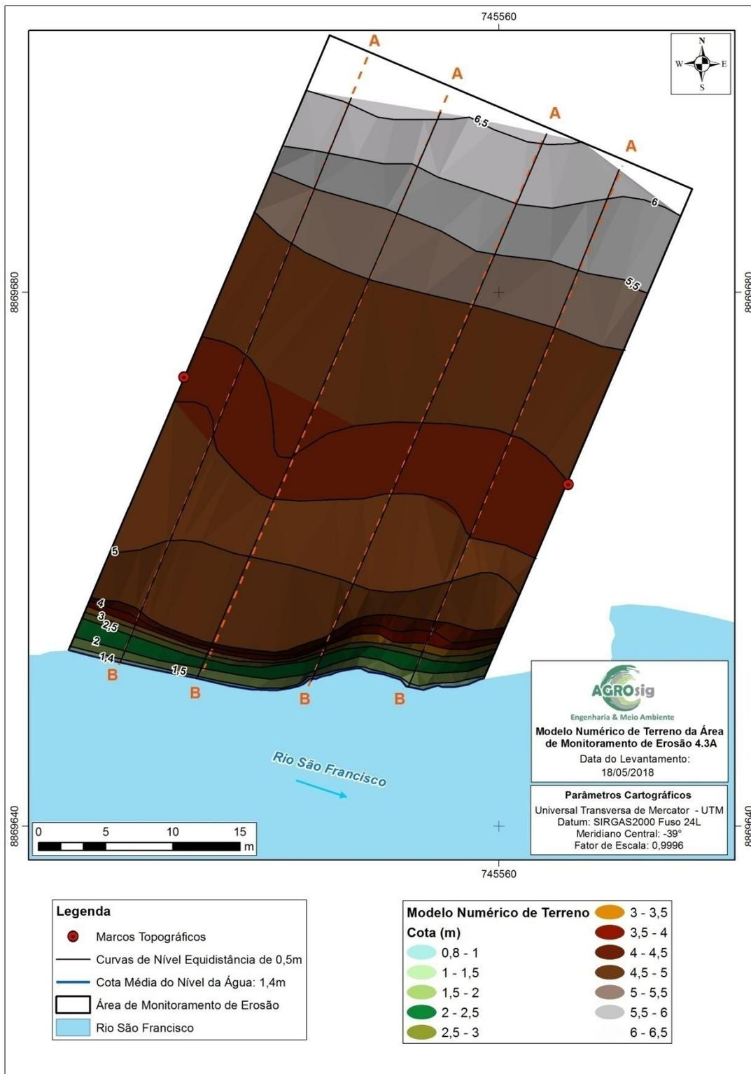
**Figura 19 - Modelo Numérico de Terreno da Área 4.3A.**
