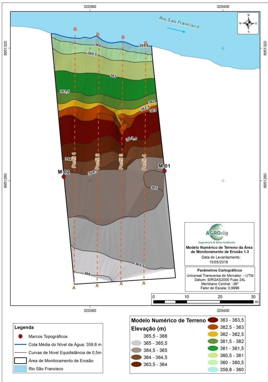
**Figura 7 - Modelo Numérico de Terreno da Área 1.3.**
