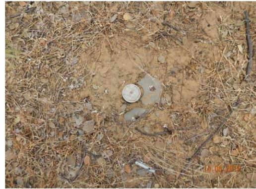
**Foto 2 - Detalhe do marco topográfico M-02.**
