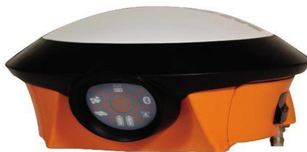
Figura 1 - GNSS marca NAVCOM modelo SF 34040 utilizado para os levantamentos em campo.
