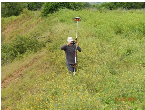
Foto 26 - Mapeamento realizado no talude monitorado.
