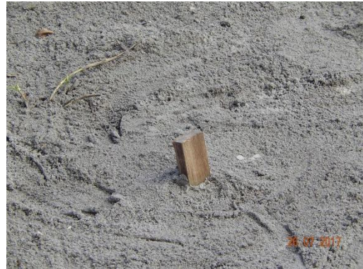
Foto 41 - Detalhe do marco topográfico M-02.
