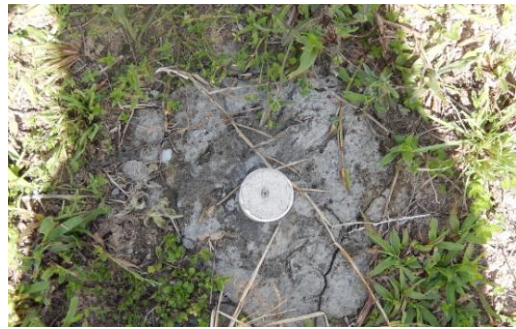
Foto 49 - Detalhe do marco topográfico M-02.
