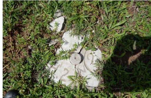
Foto 23 - Detalhe do marco topográfico M-02.
