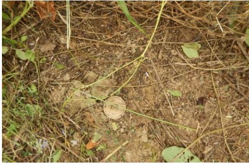
Foto 13 - Detalhe do marco topográfico M-01.
