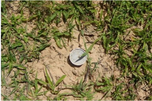
Foto 63 - Detalhe do Marco topográfico M-01.
