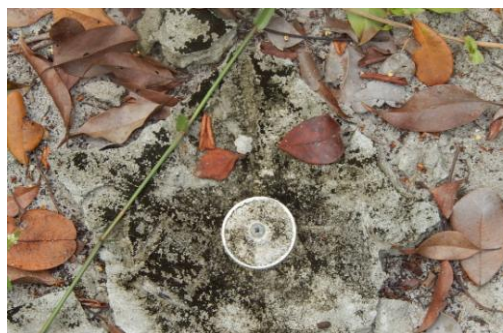
Foto 45 - Detalhe do marco topográfico M-02.
