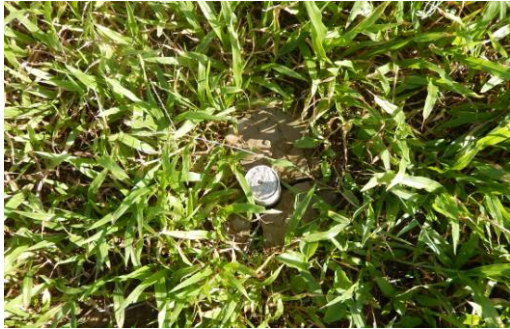
Foto 69 - Detalhe do marco topográfico M-02.
