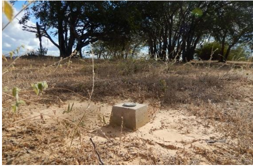
Foto 1- Detalhe do marco topográfico M-01.
