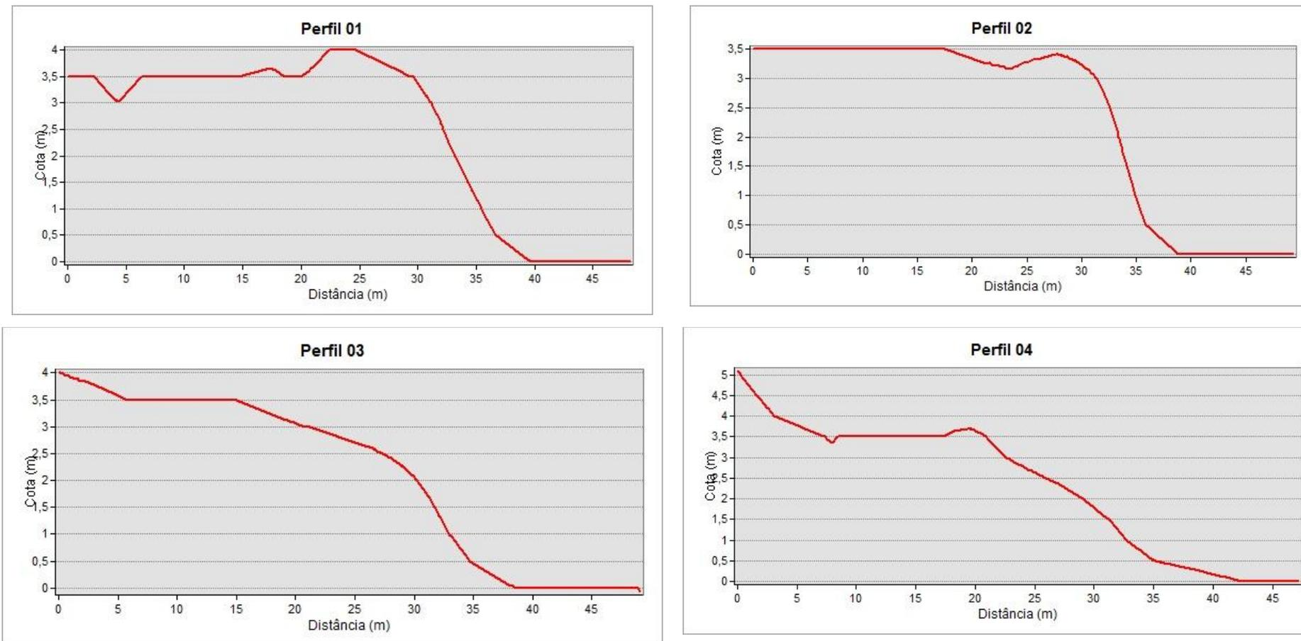
Figura 26 - Perfis de elevação gerados a partir modelo numérico de terreno da área de monitoramento 5.1A.
