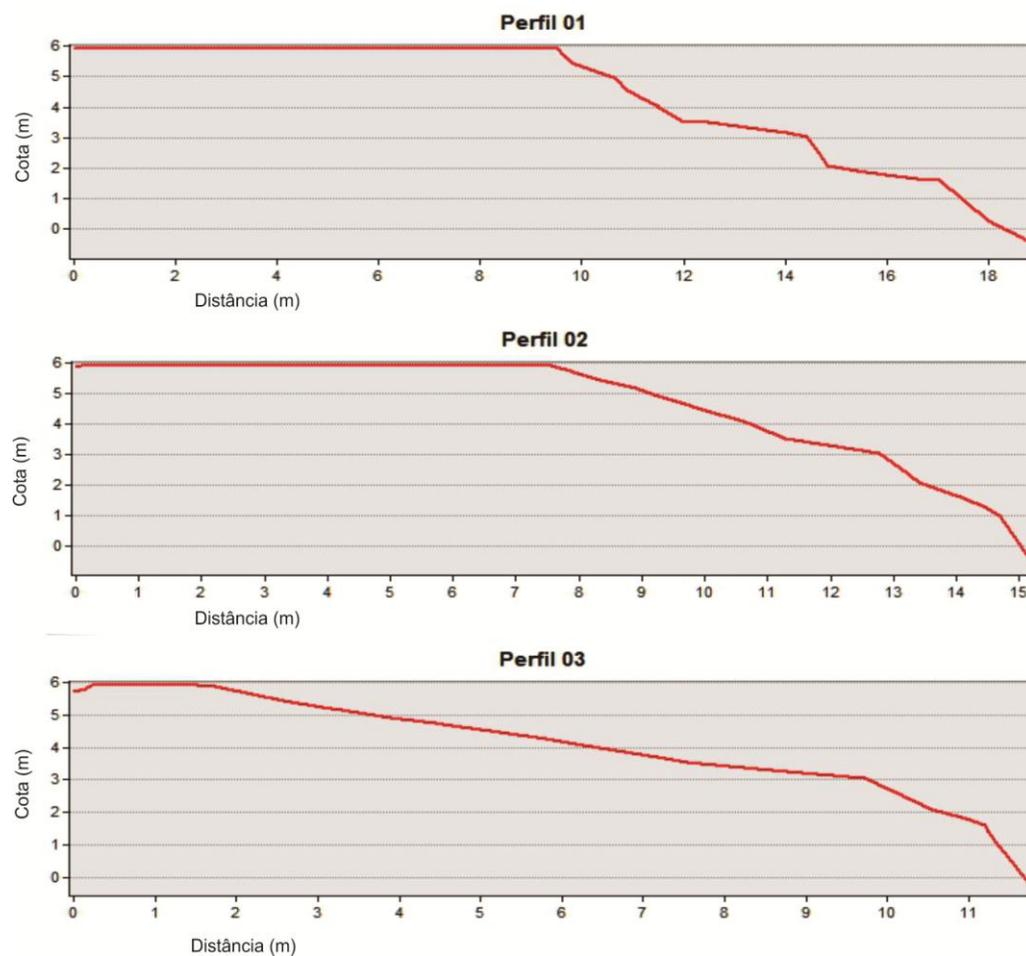
**Figura 29 - Perfis de elevação gerados a partir modelo numérico de terreno da área de monitoramento 5.1B.**
