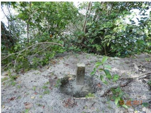
**Foto 44 - Marco topográfico M-01.**
