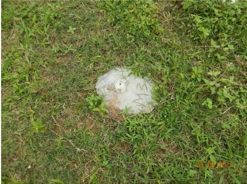
**Foto 27 - Marco topográfico M-01.**
