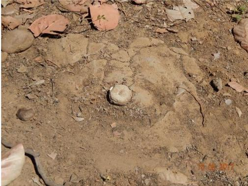
**Foto 16 - Detalhe do marco topográfico M-02.**
