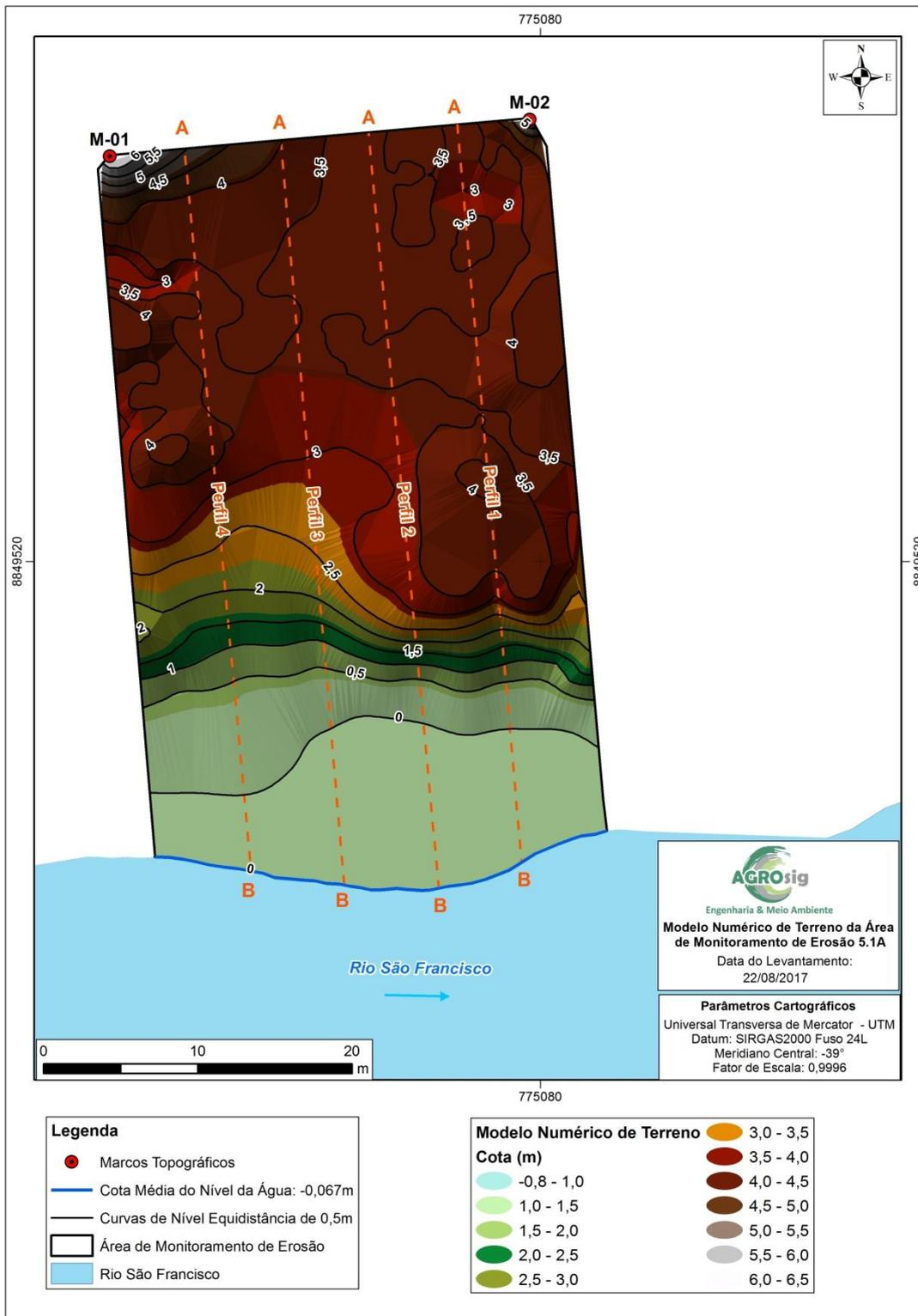
**Figura 25 - Modelo Numérico de Terreno da Área 5.1A.**
