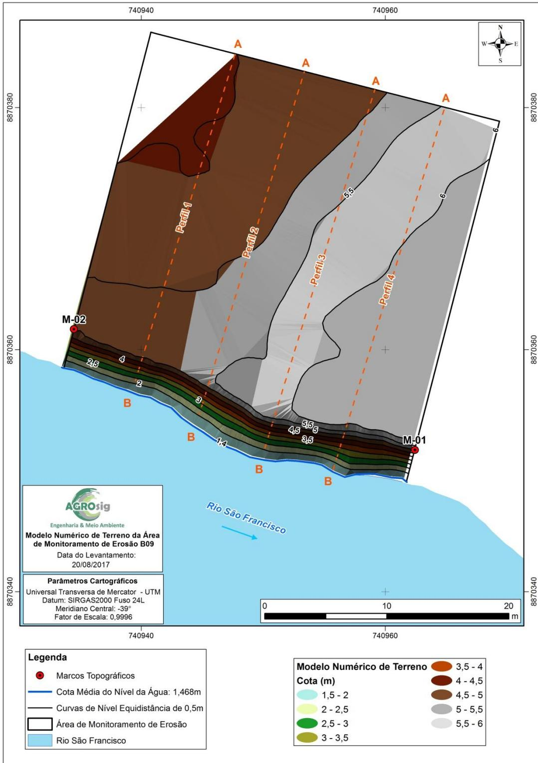
Figura 43 - Modelo Numérico de Terreno da Área B-09.
