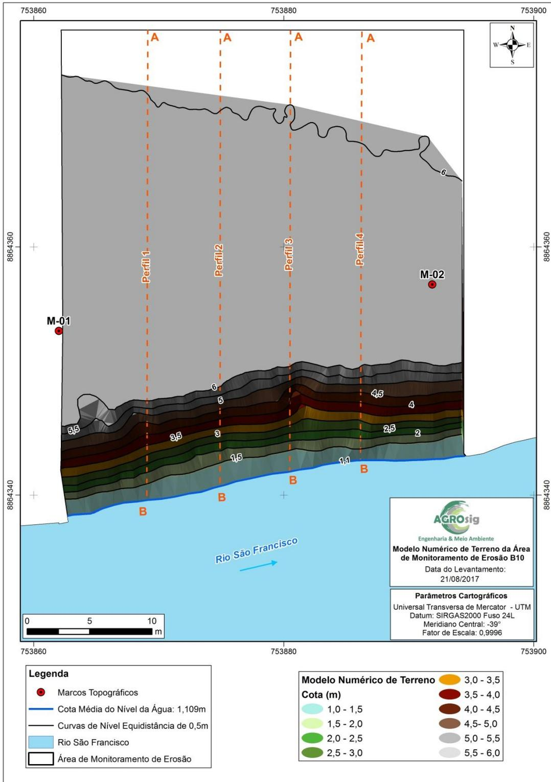
Figura 46 - Modelo Numérico de Terreno da Área B-10.
