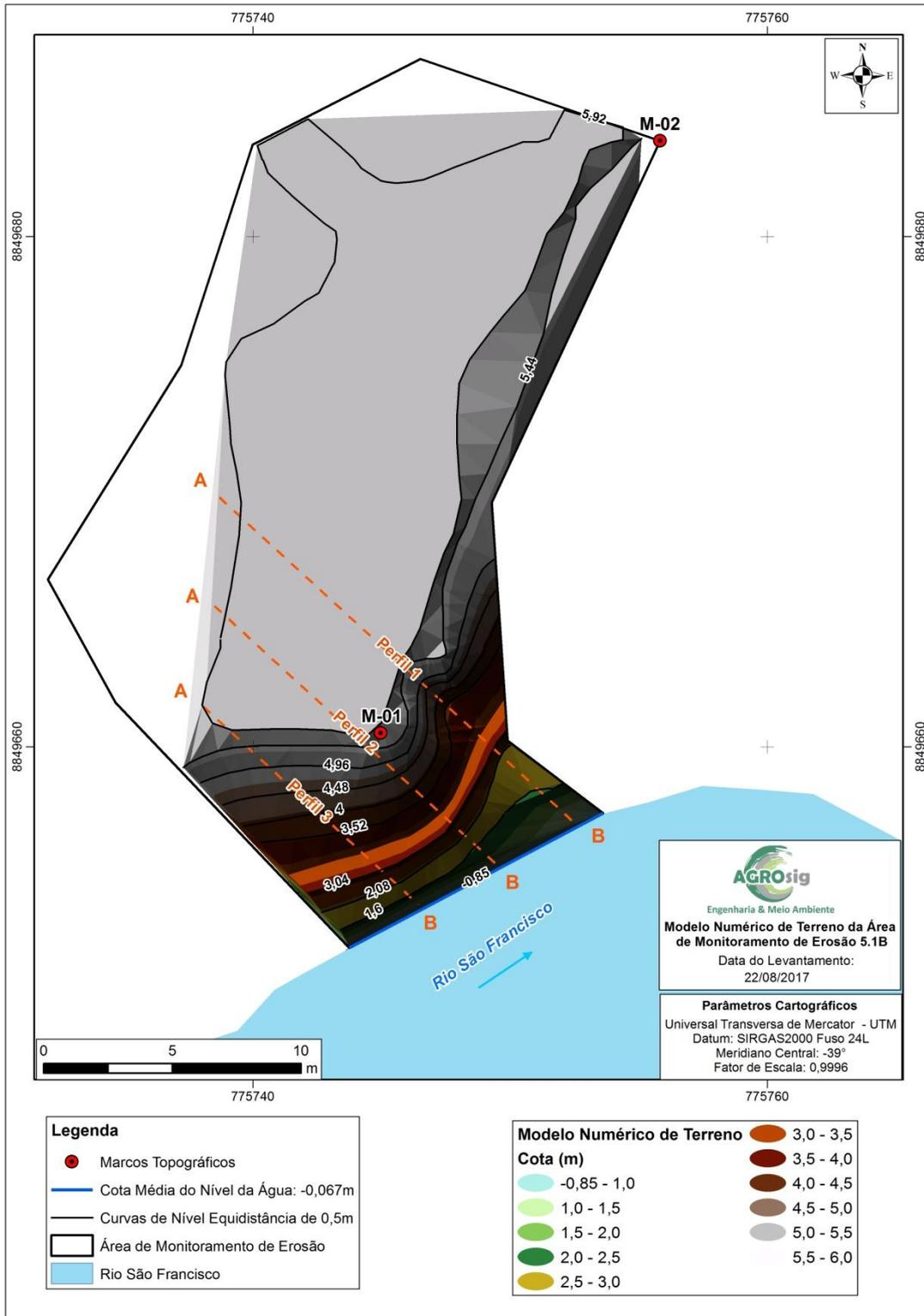
**Figura 28 - Modelo Numérico de Terreno da Área 5.1B.**
