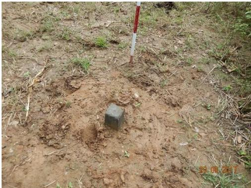
**Foto 33 - Marco topográfico M-01.**
