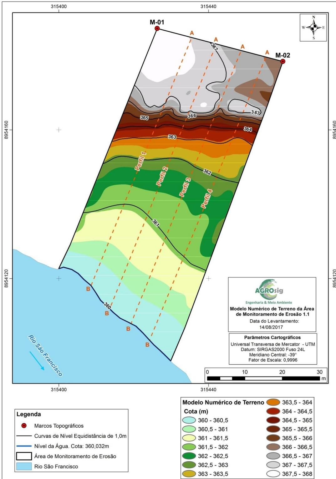
**Figura 4 - Modelo Numérico de Terreno da Área 1.1.**
