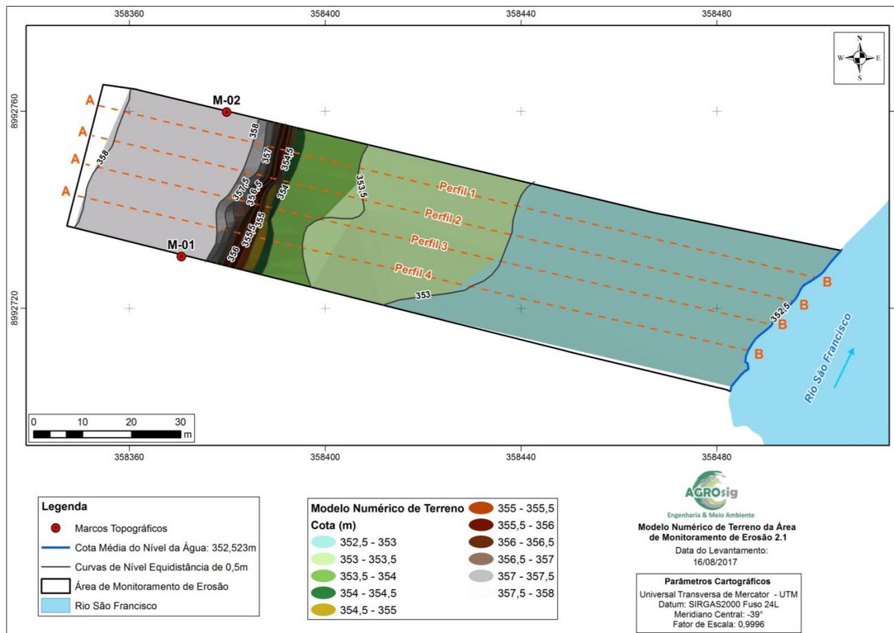
**Figura 10 - Modelo Numérico de Terreno da Área 2.1.**
