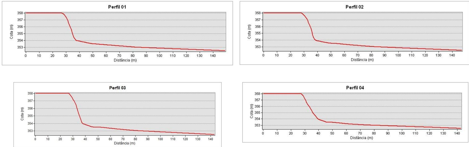
**Figura 11 - Perfis de elevação gerados a partir modelo numérico de terreno da área de monitoramento 2.1.**
