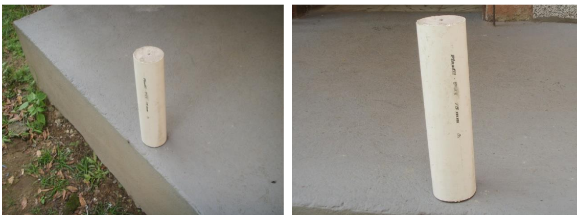
Figuras 6 e 7 – Marcos de concreto utilizados na demarcação das áreas de monitoramento dos Processos Erosivos.
