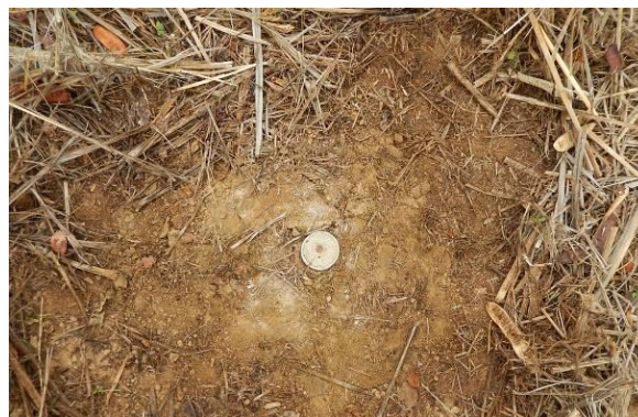
Foto 14 - Detalhe do marco topográfico M-02.
