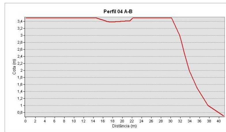
Figura 26 - Perfis de elevação gerados a partir modelo numérico de terreno da área de monitoramento 5.1A.
