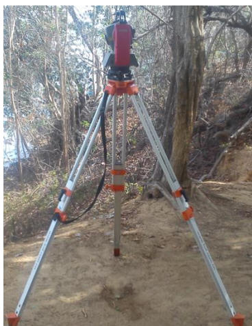
Figura 4 – Estação Total Pentax R425VN: utilizada na determinação do plano cotado e dos perfis, bem como nas leituras resultantes do levantamento planialtimétrico.
