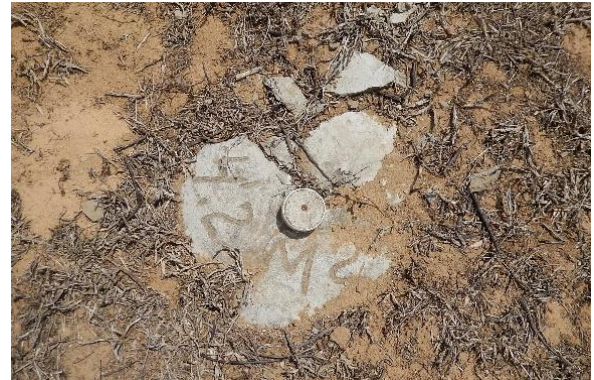
Foto 23 - Detalhe do marco topográfico M-02.
