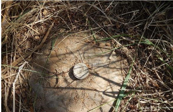
Foto 13 - Detalhe do marco topográfico M-01.
