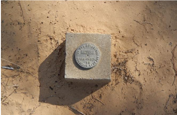
Foto 1-Detalhe do marco topográfico M-01.
