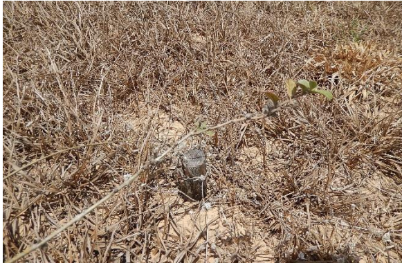
Foto 69 - Detalhe do marco topográfico M-02.
