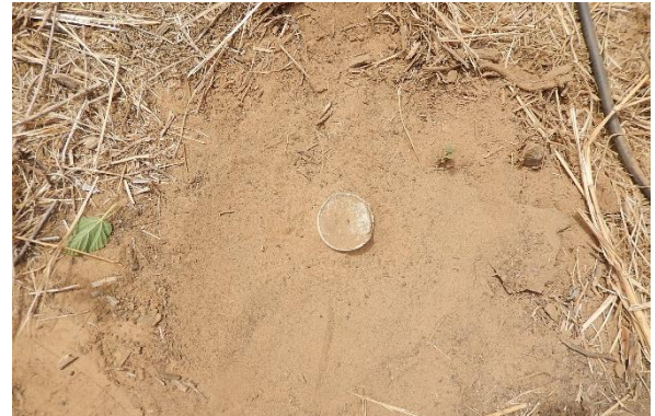
Foto 18 - Detalhe do marco topográfico M-01.
