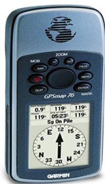
Figura 5 – GPS de Navegação Garmim map 76Sx utilizado na determinação das coordenadas de partida das estações de monitoramento.
