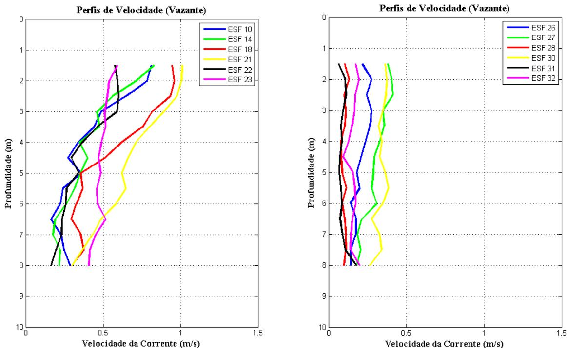
Figura 45 - Perfis verticais de velocidade de corrente para as estações amostrais em período de maré enchente. Campanha 6 - Vazante 2 - 11/08/2017.
