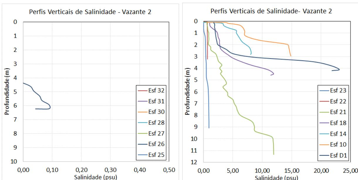
**Figura 47 - Perfis verticais de salinidade para as estações amostrais. Campanha 8 - Vazante 2 - 23/09/2017.**
