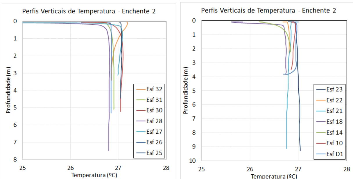
**Figura 26 - Perfis verticais de temperatura para as estações amostrais. Campanha 7 - Enchente 2 - 07/09/2017.**
