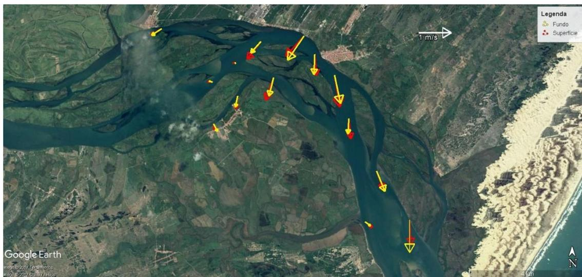
**Figura 48 - Média vertical da velocidade e direção da corrente em cada estação amostral. Campanha 8 - Enchente 2 - 23/09/2017.**
