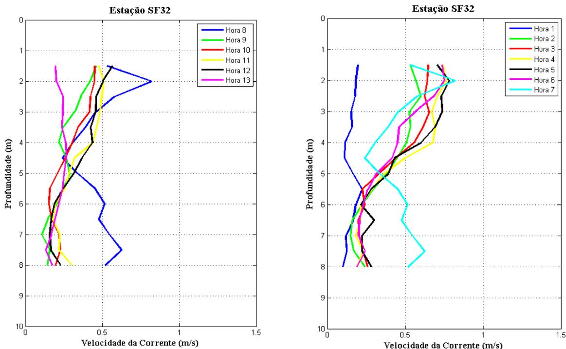
**Figura 5 - Perfis verticais de velocidade de corrente na estação fixa ESF 32. Campanha 7 - 05/09/2017.**
