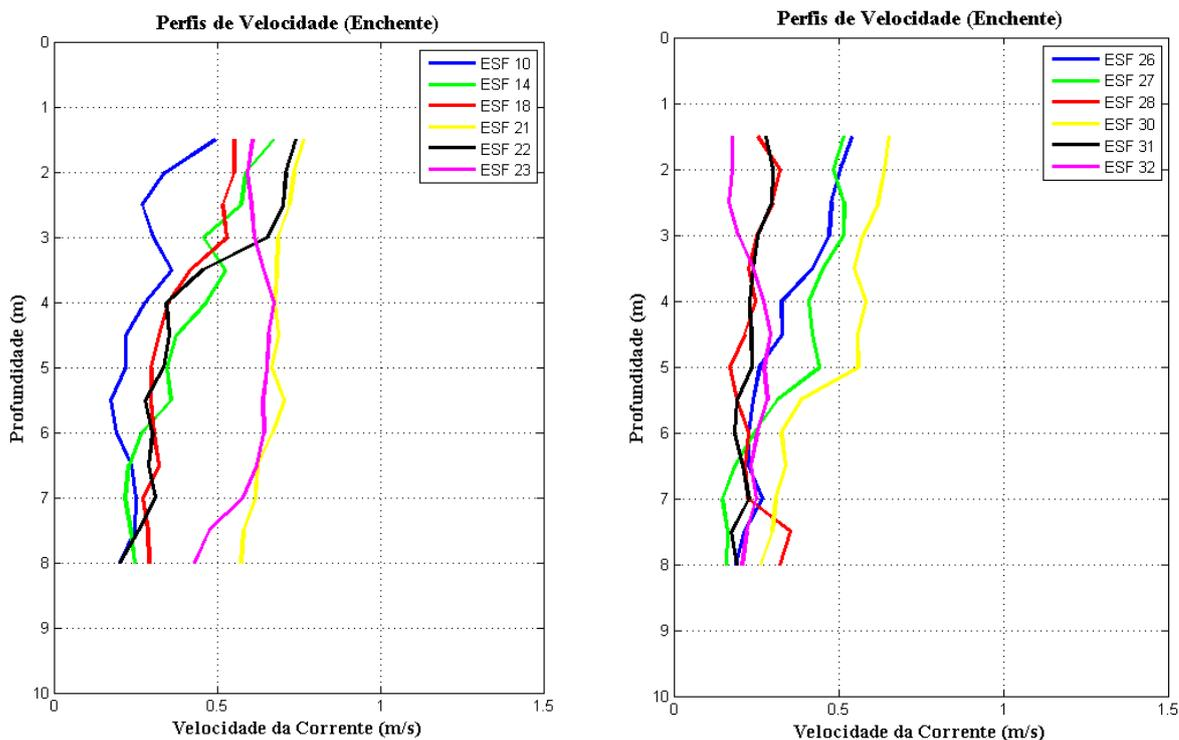
Figura 41 - Perfis verticais de velocidade de corrente para as estações amostrais em período de maré enchente. Campanha 8 - Enchente 1 - 22/09/2017.
