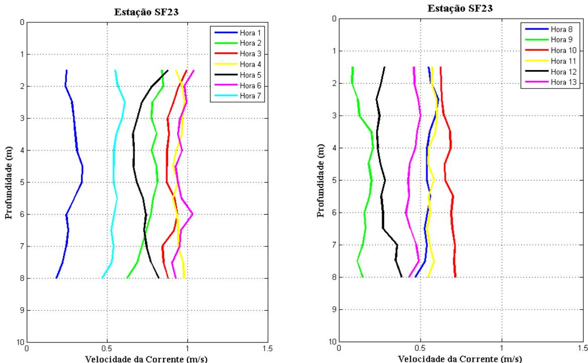
Figura 9 - Perfis verticais de velocidade de corrente na estação fixa ESF 23. Campanha 7 - 04/09/2017.
