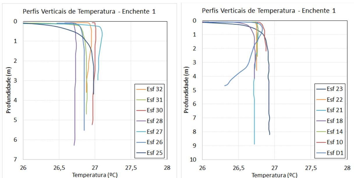
Figura 42 - Perfis verticais de temperatura para as estações amostrais. Campanha 8 - Enchente 1 - 22/09/2017.
