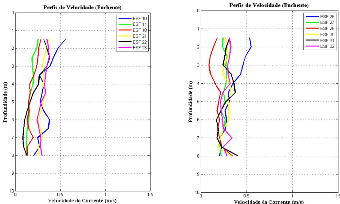
Figura 17 - Perfis verticais de velocidade de corrente para as estações amostrais em período de maré enchente. Campanha 7 - Enchente 1 - 06/09/2017.
