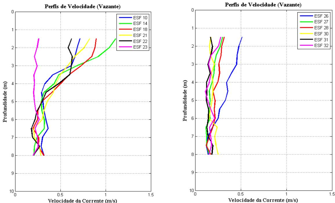
Figura 37 - Perfis verticais de velocidade de corrente para as estações amostrais em período de maré enchente. Campanha 8 - Vazante 1 - 22/09/2017.
