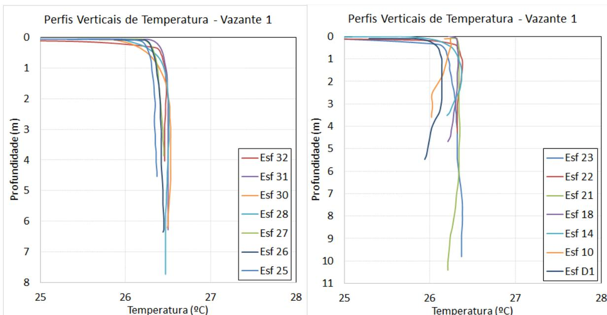
Figura 38 - Perfis verticais de temperatura para as estações amostrais. Campanha 8 - Vazante 1 - 22/09/2017.
