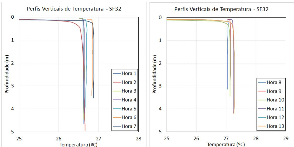
**Figura 30 - Perfis verticais de temperatura para a estação fixa ESF\_32. Campanha 2 - 13 horas - Campanha 8 - 21/09/2017.**
