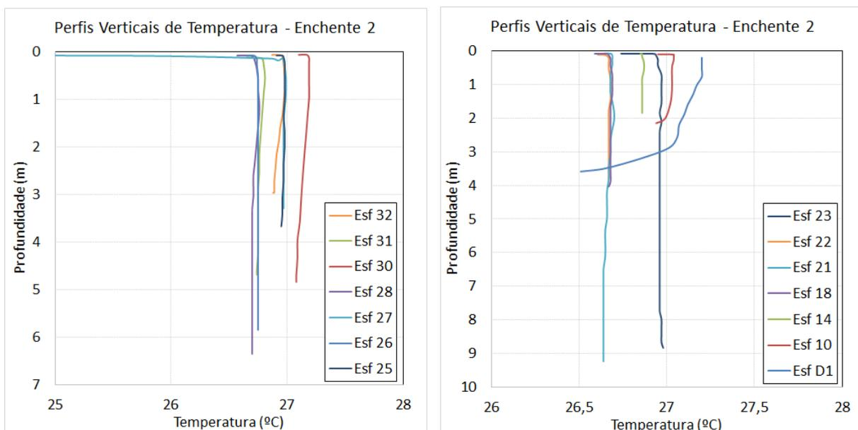
**Figura 50 - Perfis verticais de temperatura para as estações amostrais. Campanha 8 - Enchente 2 - 23/09/2017.**
