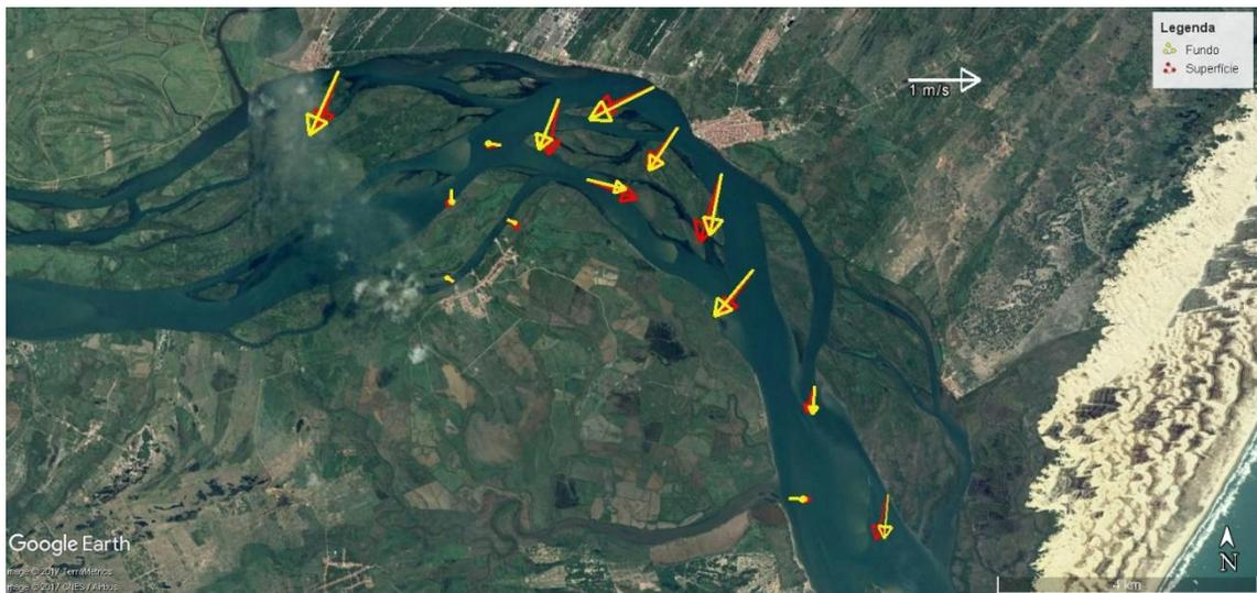
**Figura 40 - Média vertical da velocidade e direção da corrente em cada estação amostral. Campanha 8 - Enchente 1 - 22/09/2017.**
