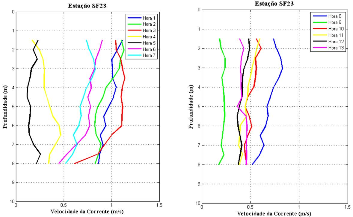
**Figura 33 - Perfis verticais de velocidade de corrente na estação fixa ESF 23. Campanha 8 - 20/09/2017.**
