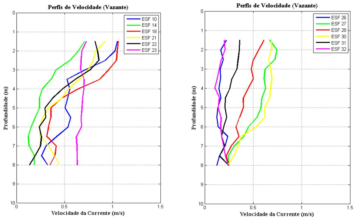
Figura 21 - Perfis verticais de velocidade de corrente para as estações amostrais em período de maré vazante. Campanha 7 - Vazante 2 - 07/09/2017.
