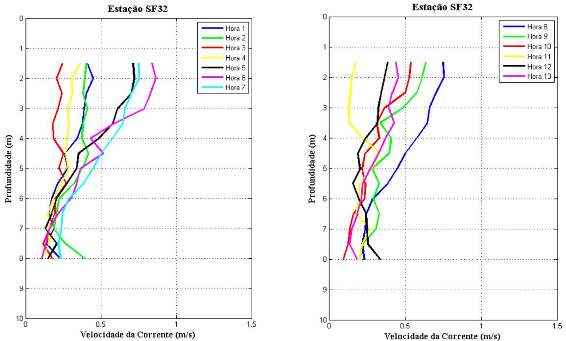
**Figura 29 - Perfis verticais de velocidade de corrente na estação fixa ESF 32. Campanha 8 - 21/09/2017.**
