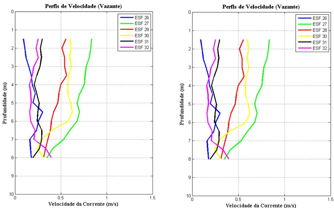
**Figura 13 - Perfis verticais de velocidade de corrente para as estações amostrais em período de maré vazante. Campanha 7 - Vazante 1 - 06/09/2017.**
