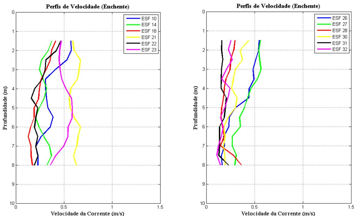
Figura 25 - Perfis verticais de velocidade de corrente para as estações amostrais em período de maré enchente. Campanha 7 - Enchente 2 - 07/09/2017.
