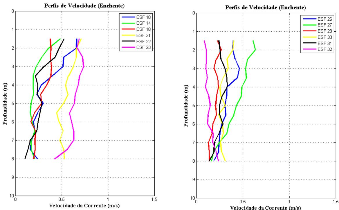
**Figura 49 - Perfis verticais de velocidade de corrente para as estações amostrais em período de maré enchente. Campanha 8 - Enchente 2 - 23/09/2017.**
