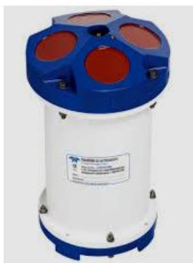
**Figura 2 - Perfilador acústico de correntes.**
