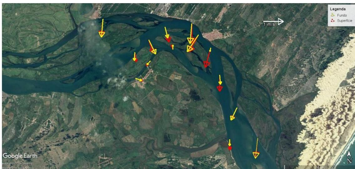
**Figura 12 - Média vertical da velocidade e direção da corrente em cada estação amostral. Campanha 3 - Vazante 1 - 24/06/2017.**
