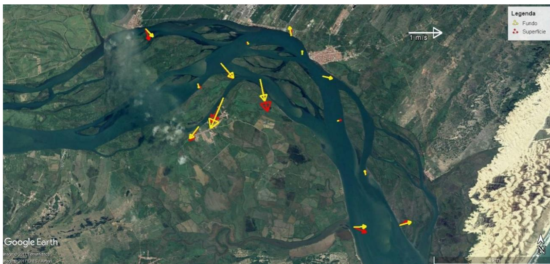
Figura 16 - Média vertical da velocidade e direção da corrente em cada estação amostral. Campanha 15 - Enchente 1 - 04/01/2018.
