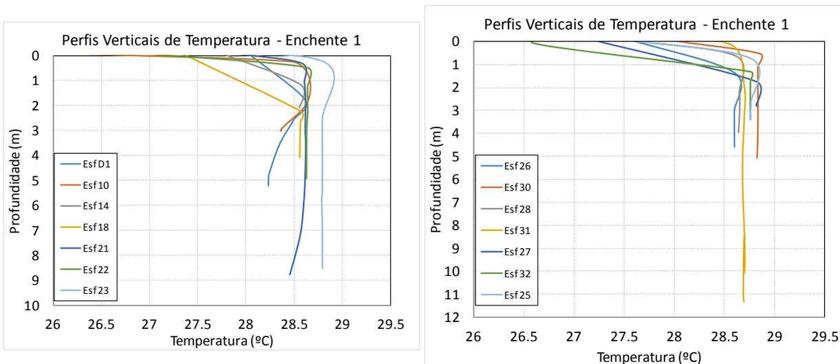
**Figura 42 - Perfis verticais de temperatura para as estações amostrais. Campanha 22 - Enchente 1 - 03/05/2018.**
