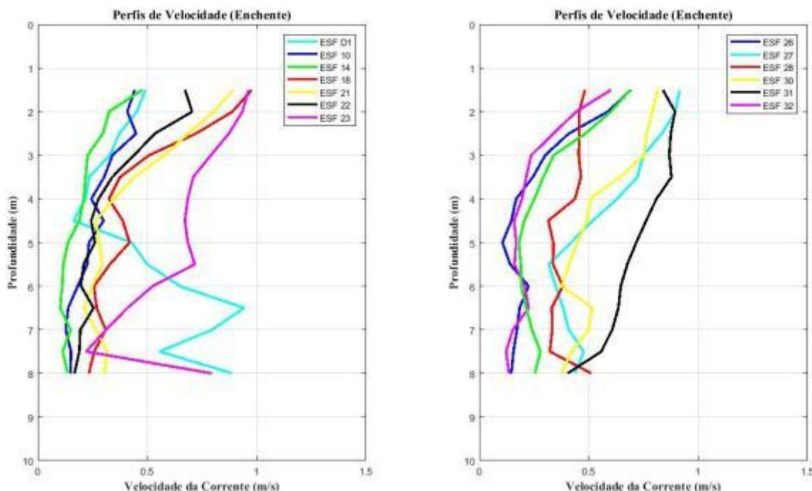
**Figura 49 - Perfis verticais de velocidade de corrente para as estações amostrais em período de maré enchente. Campanha 22 - Enchente 2 - 04/05/2018.**
