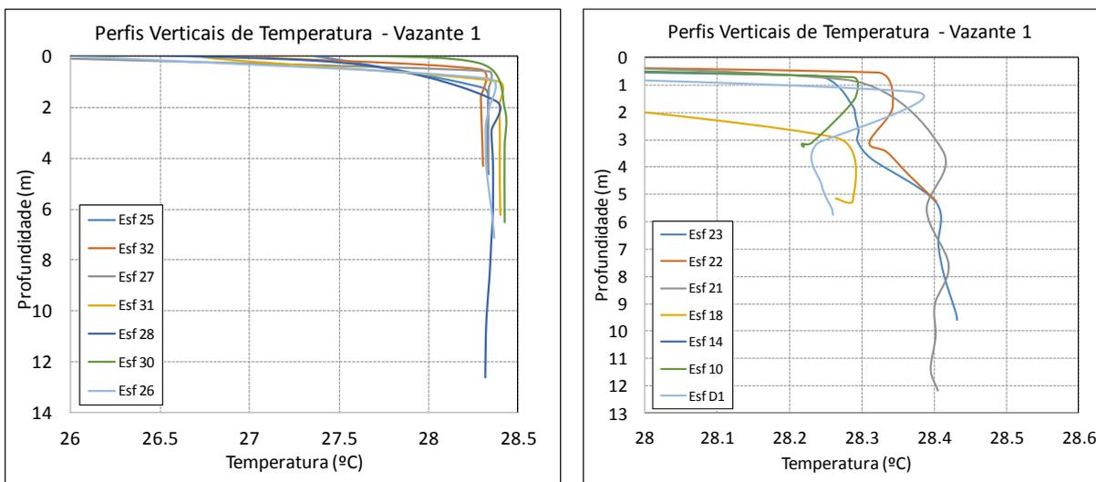
**Figura 38 - Perfis verticais de temperatura para as estações amostrais. Campanha 22 – Vazante 1 - 03/05/2018.**
