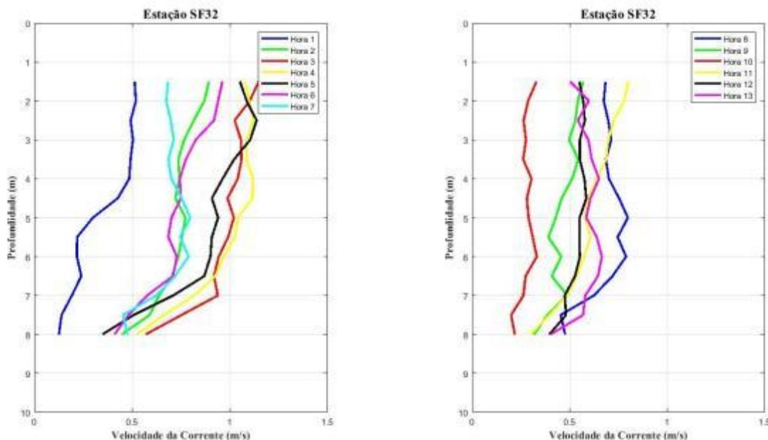
**Figura 5 - Perfis verticais de velocidade de corrente na estação fixa ESF 32. Campanha 21 - 16/04/2018.**
