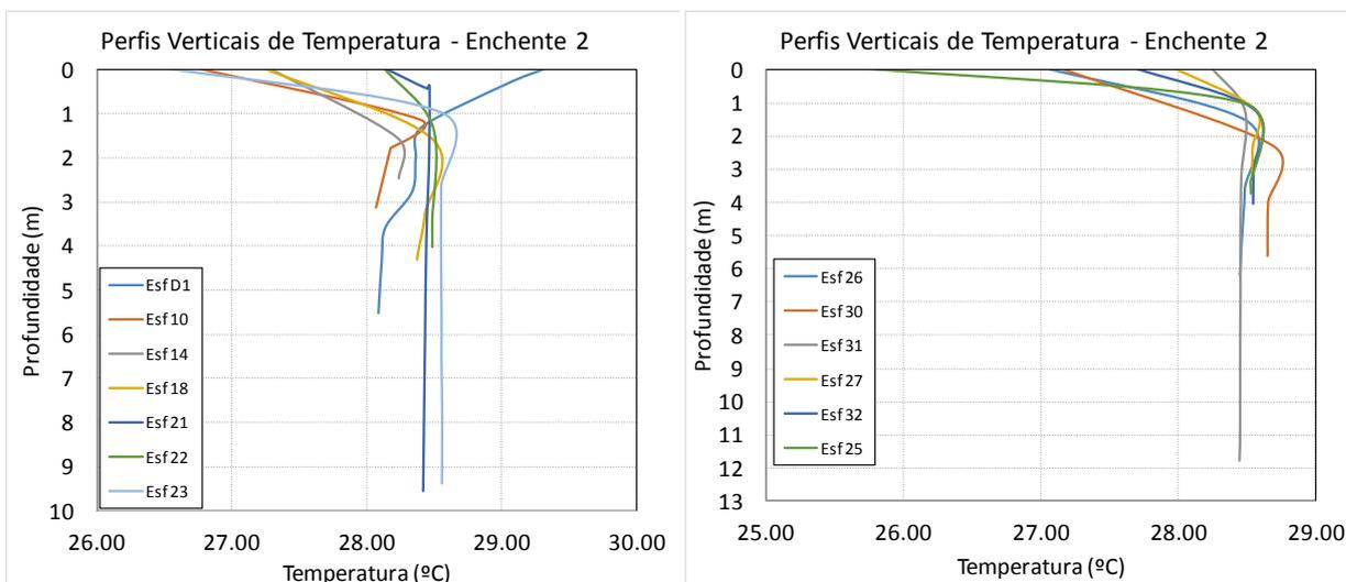
**Figura 50 - Perfis verticais de temperatura para as estações amostrais. Campanha 22 - Enchente 2 - 04/05/2018.**
