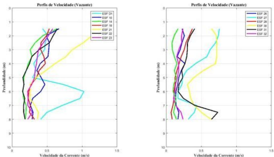
**Figura 13 - Perfis verticais de velocidade de corrente para as estações amostrais em período de maré vazante. Campanha 21 - Vazante 1 - 17/04/2018.**
