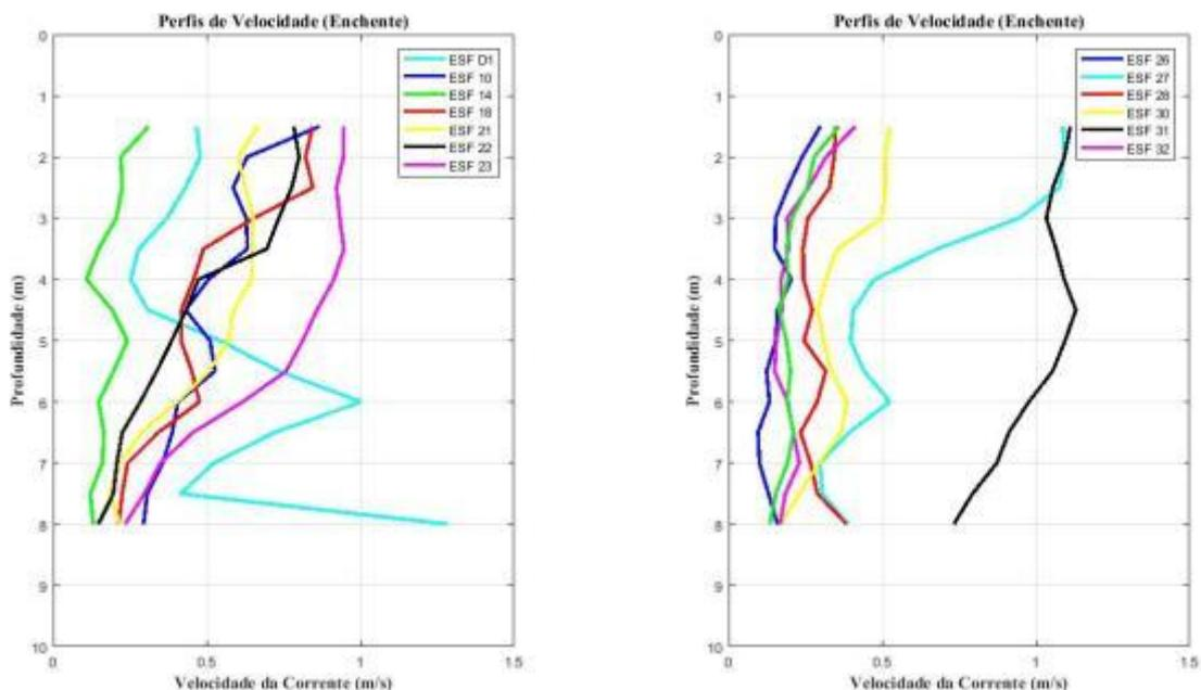
**Figura 25 - Perfis verticais de velocidade de corrente para as estações amostrais em período de maré enchente. Campanha 21 - Enchente 2 - 18/04/2018.**
