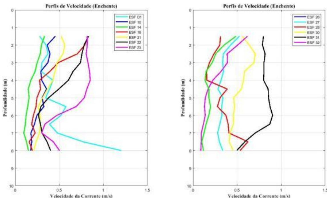
**Figura 41 - Perfis verticais de velocidade de corrente para as estações amostrais em período de maré enchente. Campanha 22 - Enchente 1 - 03/05/2018.**
