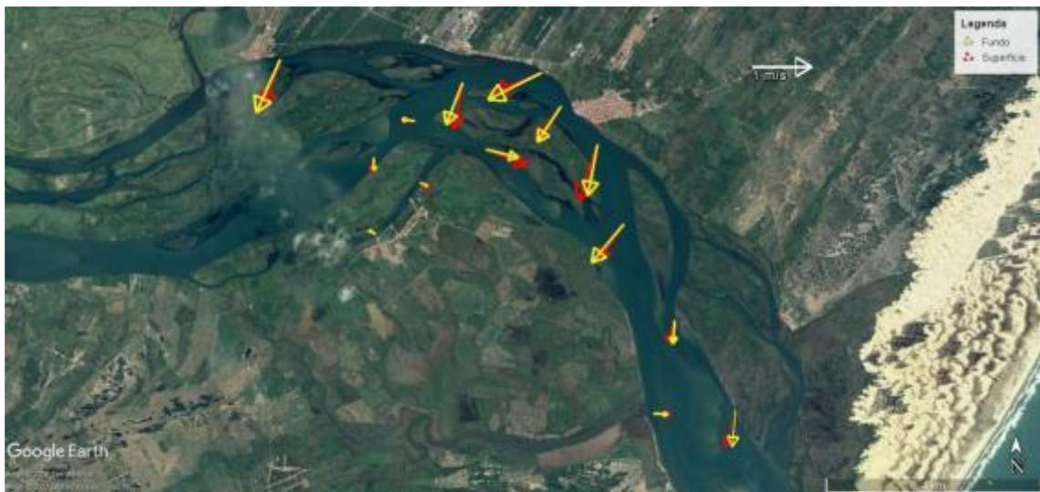
**Figura 40 - Média vertical da velocidade e direção da corrente em cada estação amostral. Campanha 22 - Enchente 1 - 03/05/2018.**
