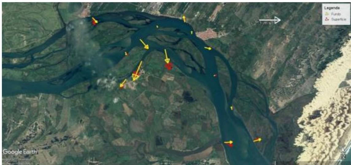
Figura 16 - Média vertical da velocidade e direção da corrente em cada estação amostral. Campanha 21 - Enchente 1 - 17/04/2018.
