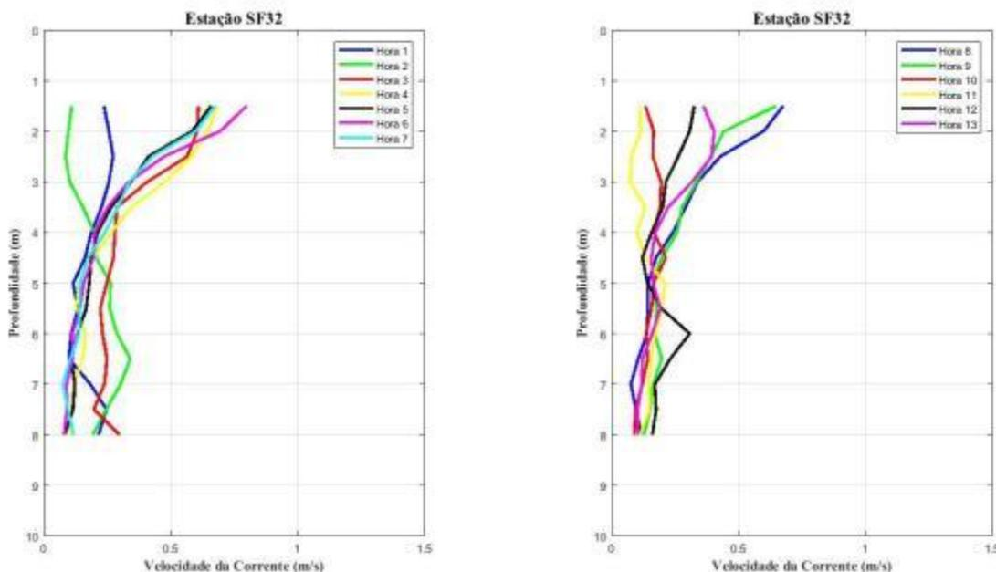
**Figura 29 - Perfis verticais de velocidade de corrente na estação fixa ESF 32. Campanha 22 - 02/05/2018.**
