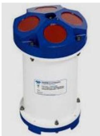
Figura 2 - Perfilador acústico de correntes.
