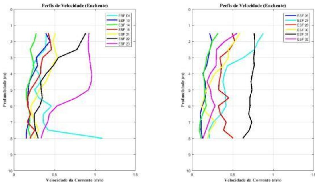
**Figura 17 - Perfis verticais de velocidade de corrente para as estações amostrais em período de maré enchente. Campanha 21 - Enchente 1 - 17/04/2018.**
