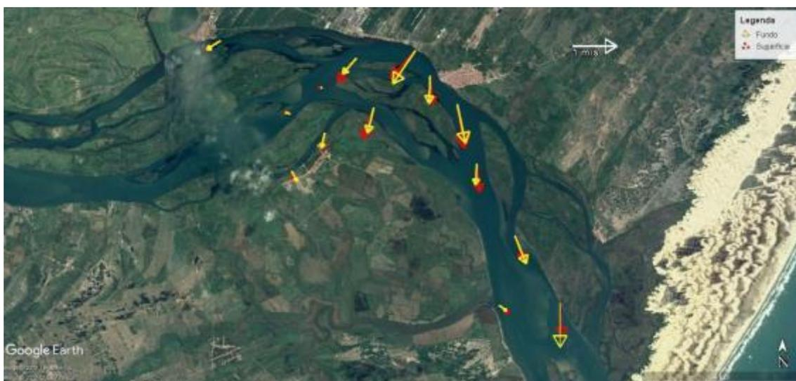
Figura 48 - Média vertical da velocidade e direção da corrente em cada estação amostral. Campanha 22 - Enchente 2 - 04/05/2018.
