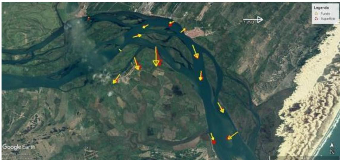
Figura 24 - Média vertical da velocidade e direção da corrente em cada estação amostral. Campanha 21 - Enchente 2 - 18/04/2018.
