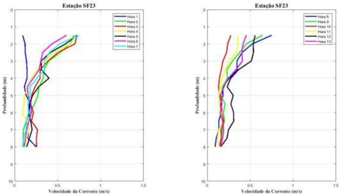
Figura 9 - Perfis verticais de velocidade de corrente na estação fixa ESF 23. Campanha 21 - 15/04/2018.
