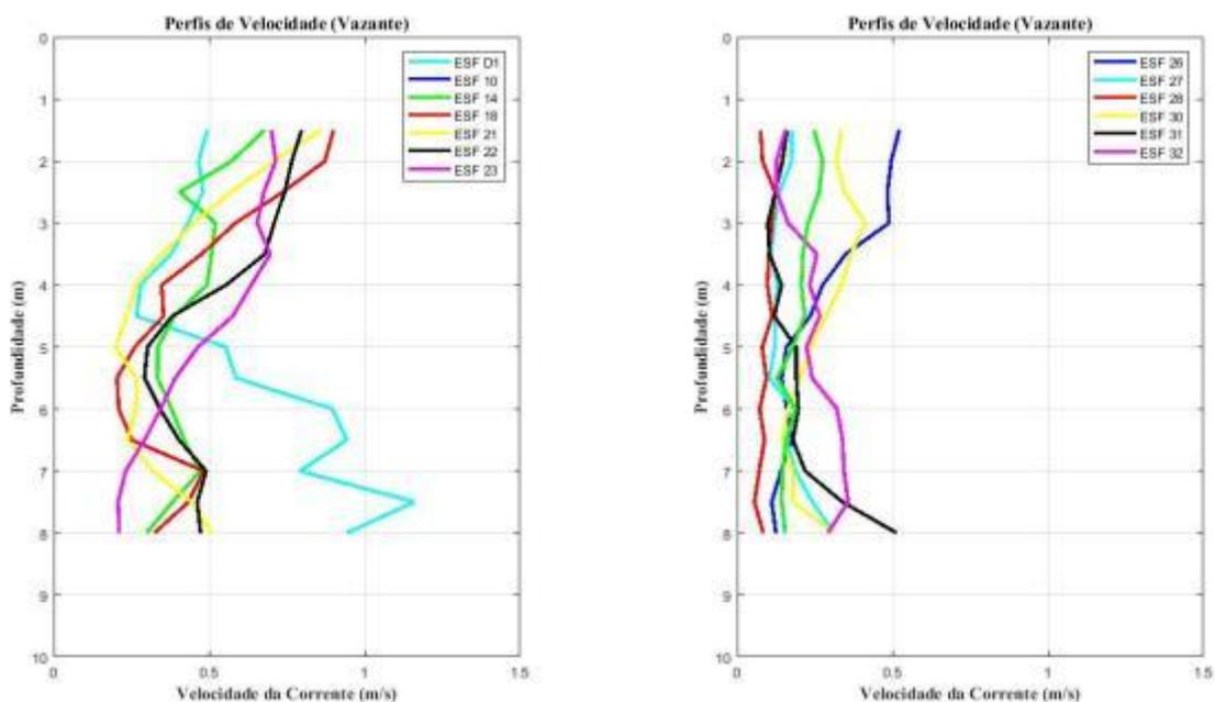
Figura 21 - Perfis verticais de velocidade de corrente para as estações amostrais em período de maré vazante. Campanha 21 - Vazante 2 - 18/04/2018.
