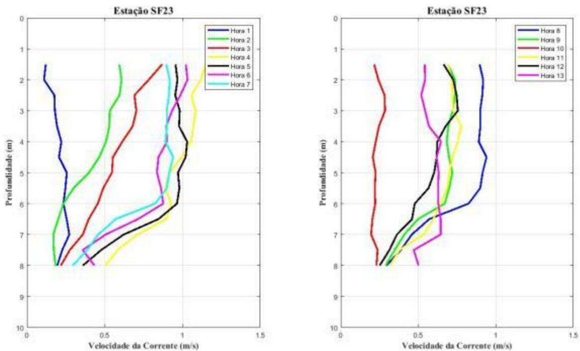
Figura 33 - Perfis verticais de velocidade de corrente na estação fixa ESF 23. Campanha 22 - 01/05/2018.
