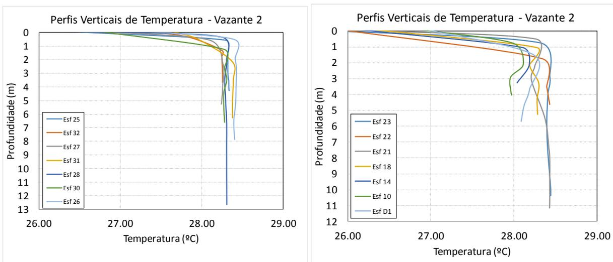
**Figura 46 - Perfis verticais de temperatura para as estações amostrais. Campanha 22 - Vazante 2 - 04/05/2018.**
