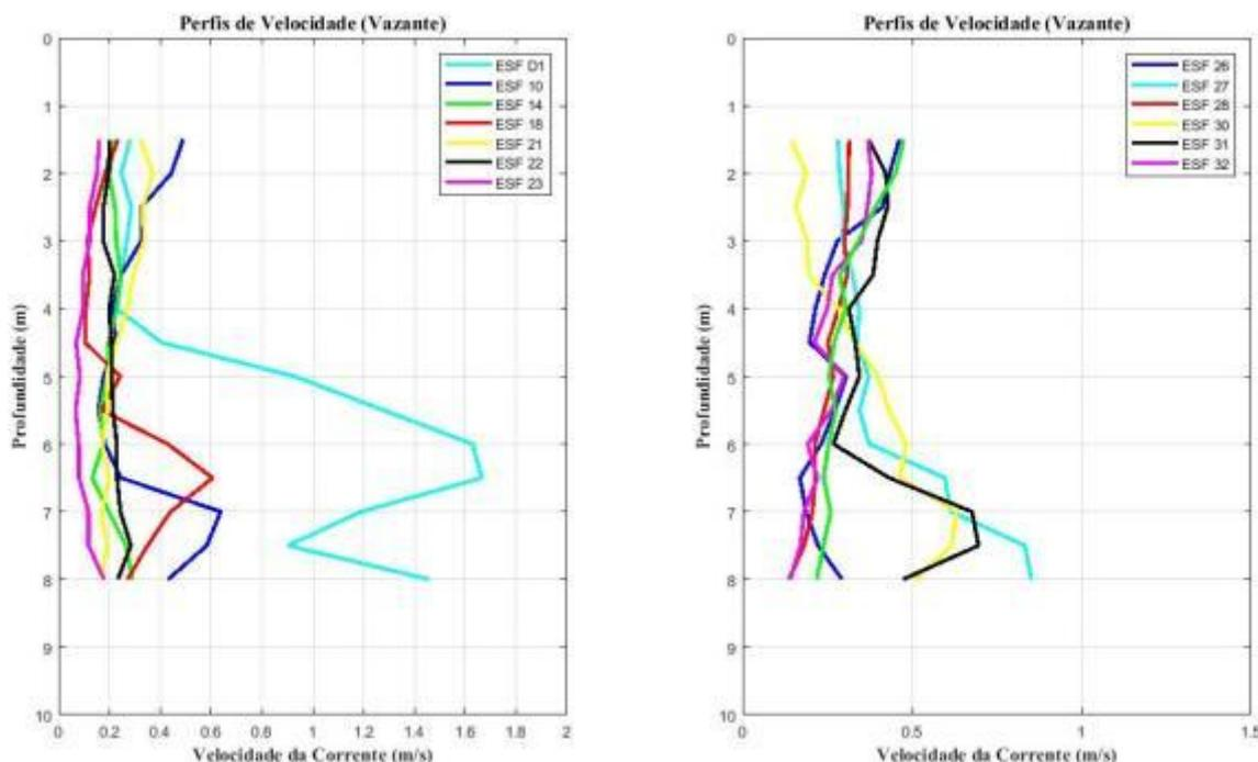
**Figura 45 - Perfis verticais de velocidade de corrente para as estações amostrais em período de maré vazante. Campanha 22 - Vazante 2 - 04/05/2018.**
