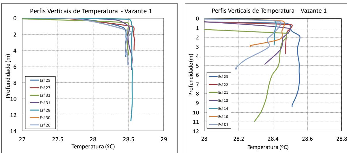
**Figura 14 - Perfis verticais de temperatura para as estações amostrais. Campanha 21- Vazante 1 - 17/04/2018.**
