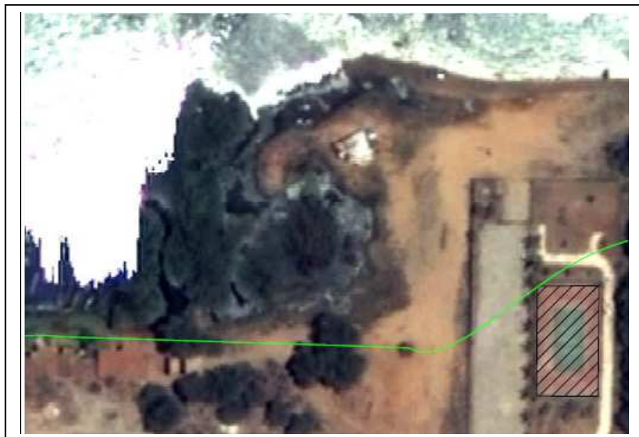
Figura 05 – Linha d'água referente à cota de 361,44 m, correspondente à vazão de 3.600 \text{ m}^3/\text{s} , sobre imagem do satélite QUICKBIRD .
