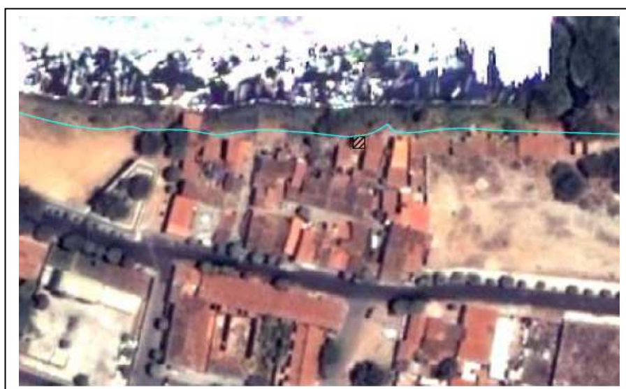
Figura 04 – Primeira residência do Angary alcançada pela linha da cota 361,75 m, correspondente à vazão de 4.106 m³/s, sobre imagem do satélite QUICKBIRD.
